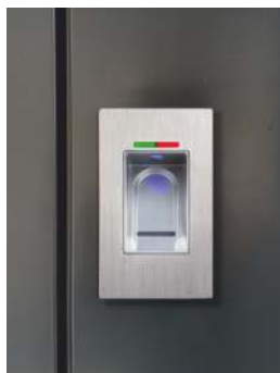
Öffnung der Haustüre mit Idencom Fingerprint
