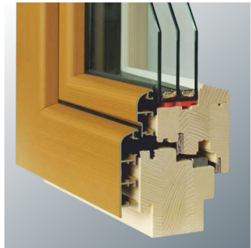
Ausführung flächenversetzt runder Rahmen und Flügel.
