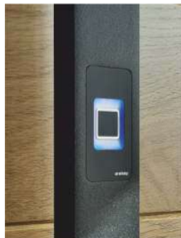
Griff mit integriertem dLine Fingerprint
